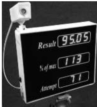
Рис.9. – Акустический приемник, расположенный на корпусе блока индикации измерительной системы кнопку калибровки. В течение 3х секунд производится измерение несущей частоты излучателя при нулевой скорости снаряда, после чего приступает к измерениям. Светящийся светодиод на передней панели приемника свидетельствует о наличии несущей частоты. Измерения начинаются при превышении пороговой скорости снаряда и далее выполняются вычисления в соответствии с приведенным алгоритмом (рис. 10).
