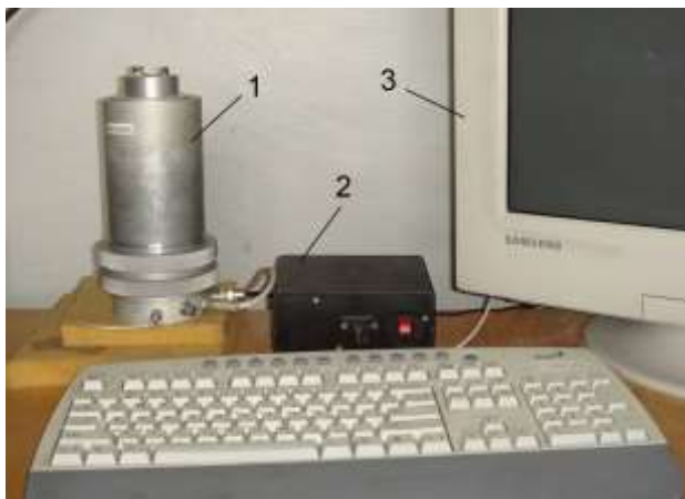
Рис. 1 – Внешний вид спектрометрического стенда для измерения сцинтиляционных характеристик детекторов на основе системы сцинтиллятор – PIN ФД. 1 – измерительная камера; 2 – спектрометр; 3 – монитор ПЭВМ.
