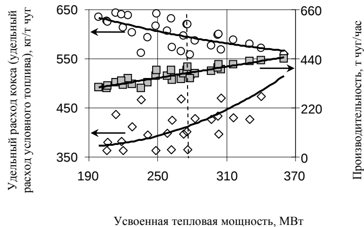
Рис. 1 – Характеристики решения задачи поиска компромиссных решений в области «производительность- удельный расход кокса – удельный расход условного топлива»: о- удельный расход условного топлива, ■- производительность, ◇- удельный расход кокса, (—) – линия тенденций показателей плавки, (- - -)оценка варианта теплового режима
