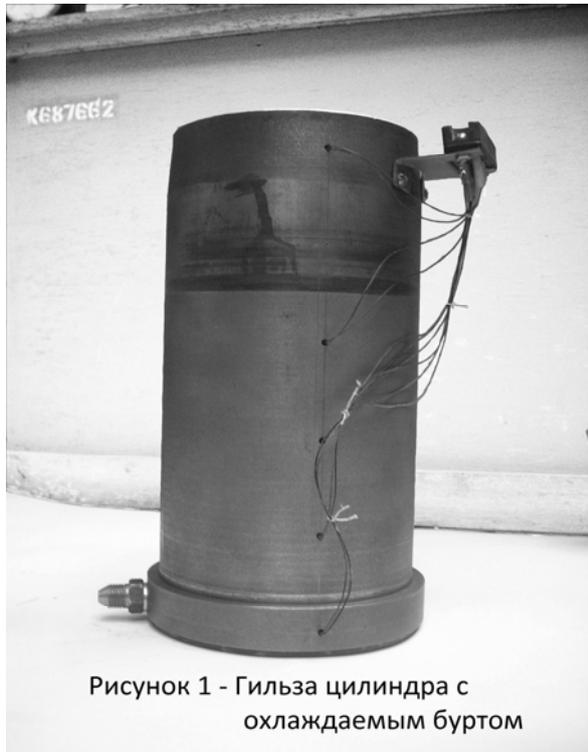
Рисунок 1 - Гильза цилиндра с охлаждаемым буртом
