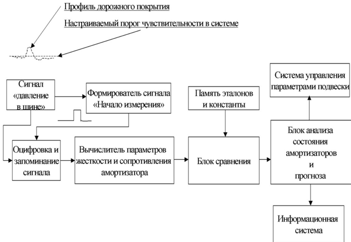
Рисунок 3 – Блок-схема бортового устройства и алгоритм обработки сигнала с одного колеса
