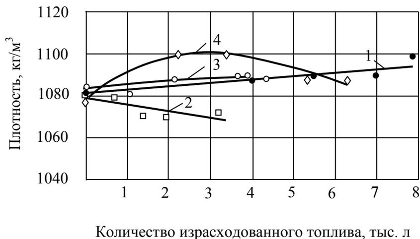
Рисунок 2 – Изменение плотности антифриза от количества израсходованного топлива:
