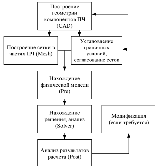
Рис. 2 – Алгоритм расчета пространственного течения жидкости с помощью специальной программы
