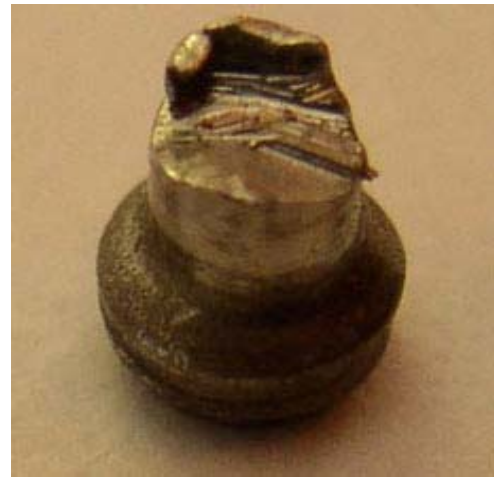
Рис. 6 – Руйнування шийки штока від утоми (матеріал – сталь 08X18H10)
