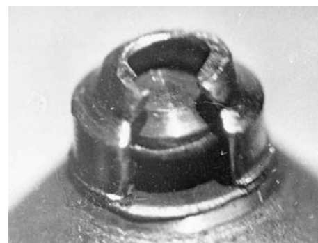
Рис. 3 – Вузол кріплення штока і повзуна після виробітку ресурсу клапана
