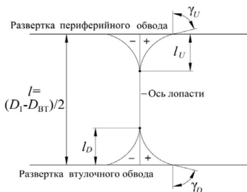
Рис. 1 – Схема сложного окружного навала лопатей РК
