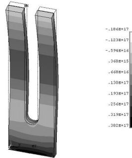
Рисунок 2 – 5-ая собственная частот пьезоэлектрического резонатора
