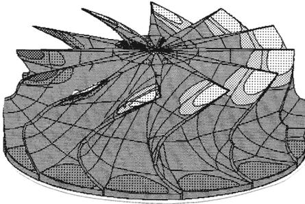
Рисунок 1 – 15-ая собственная частота рабочего колеса турбины ТКР-8.5-ТВ.
