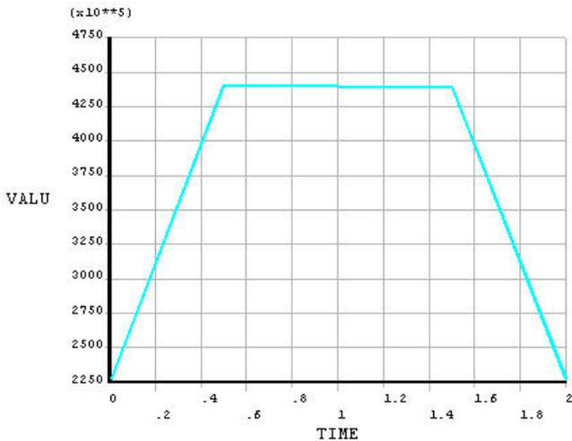
Рисунок 7 – График изменения эквивалентных напряжений во времени
