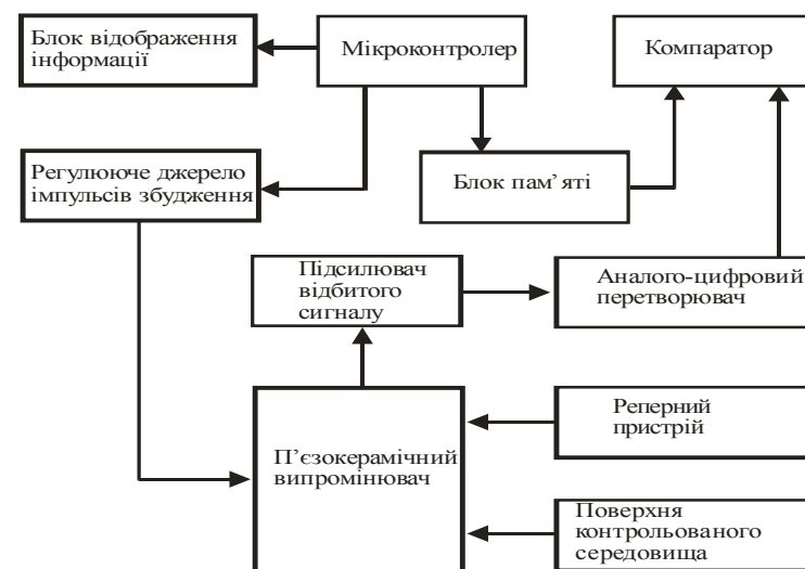
Рис. 1. Структурна схема компенсаційного ультразвукового рівнеміра
