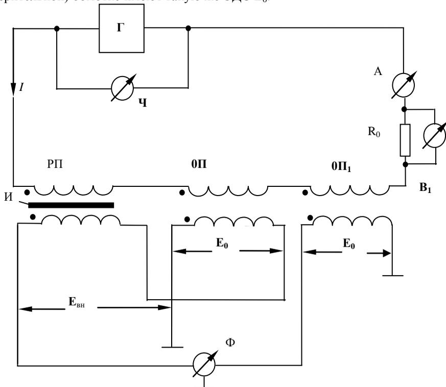
Рис. 1. Схема включения ТЕМП с цилиндрическим изделием
