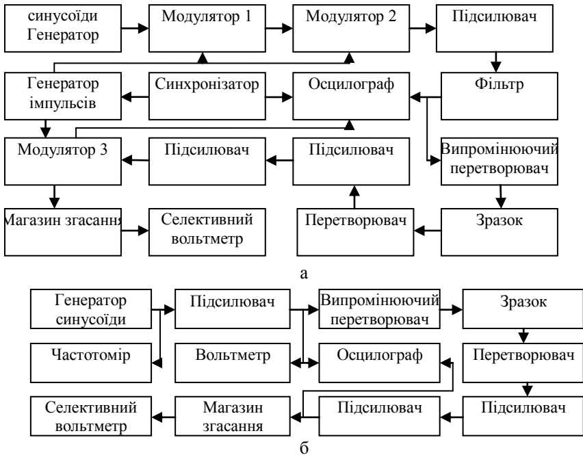
Рис. 2. Структурні схеми вимірювання імпульсним методом (а) та методом безперервного синусоїдального випромінювання (б)
