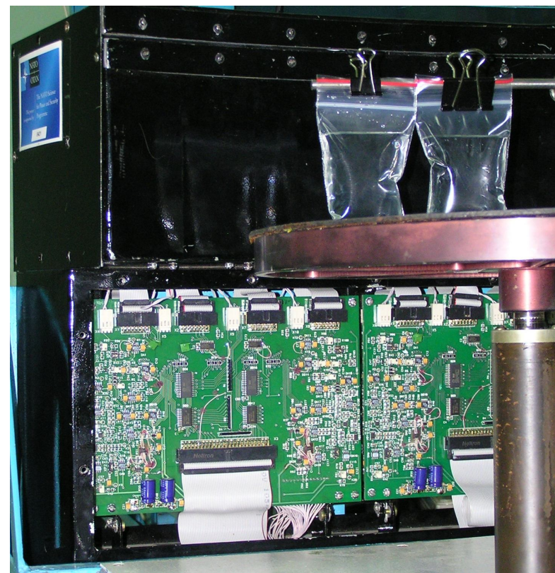
Рис. 5. Зовнішній вигляд ОК - вода ( H_2O ) та гліцерин Z_{\text{eff}} \approx 6.87 (у поліетиленових пакетиках).
