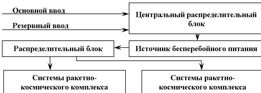
Рис. 2. Централизованная структура системы гарантированного электроснабжения
