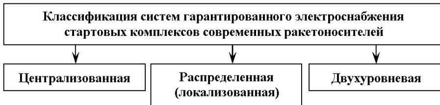
Рис. 1. Классификация систем гарантированного электроснабжения
