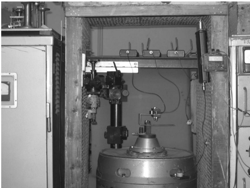
Рис. 4. Система для анализа сигналов АЭ в процессе резонансного нагружения образцов.
