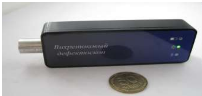
Рис. 2. Загальний вид вихрострумового дефектоскопу з телеметричним каналом зв'язку
