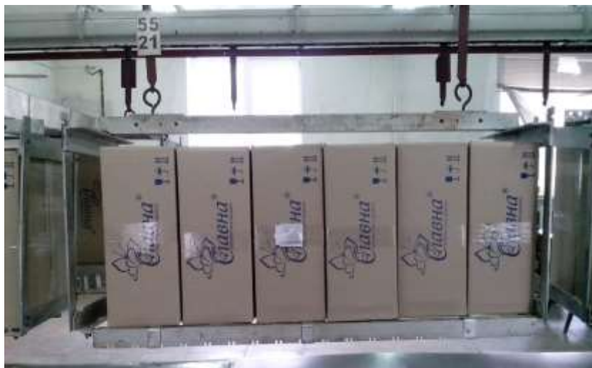
Рис. 4 – Транспортный контейнер с обрабатываемыми изделиями и дозиметром Harwell RedPerspex 4034
