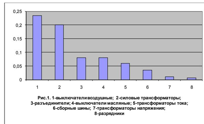
Как видно из этого рисунка, чаще всего выходят из нормального режима работы выключатели, силовые трансформаторы и разъединители. Такая тенденция отмечается и для оборудования на подстанциях 750кВ и 220кВ.
