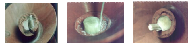
Рис. 2 – Внешний вид «хрупкого разрушения» полимерного изолятора
