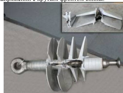
Рис.2 – Изолятор типа ПСК 120-3,3-7, пробитый импульсным напряжением с крутым фронтом волны
