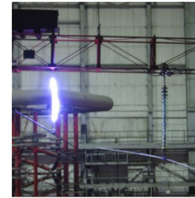
Рис. 5 – Перекрытие полимерного изолятора ЛК 70 – 150 – 5 при параллельном подключении гирлянды и полимерного изолятора к источнику импульсного напряжения.
