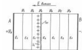
Рис. 3 – Многослойный диэлектрик, заключенный между электродами А и В.
