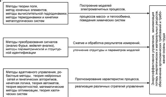
Рис. 3 – Математический базис систем автоматического управления электропечными установками
