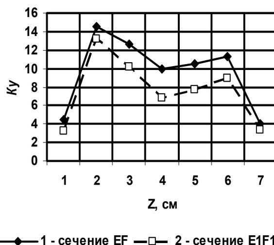
Рис. 9. Распределение безразмерных напряжений  $K_{y\max}$  по толщине хвоста. Модель 6
