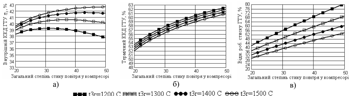
Рис. 3. Результати досліджень впливу температури газу t_{3r} на вході у газову турбину безрегенеративної автономної ГТУ на внутрішній ККД ГТУ (а), термічний ККД ГТУ (б) і відносну роботу стиску (в)
