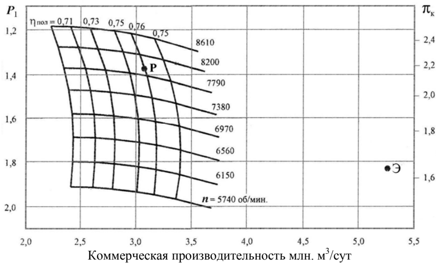
Рис. 2 – Эталонная характеристика ЦБК Ц-6,3А/30-2,2
