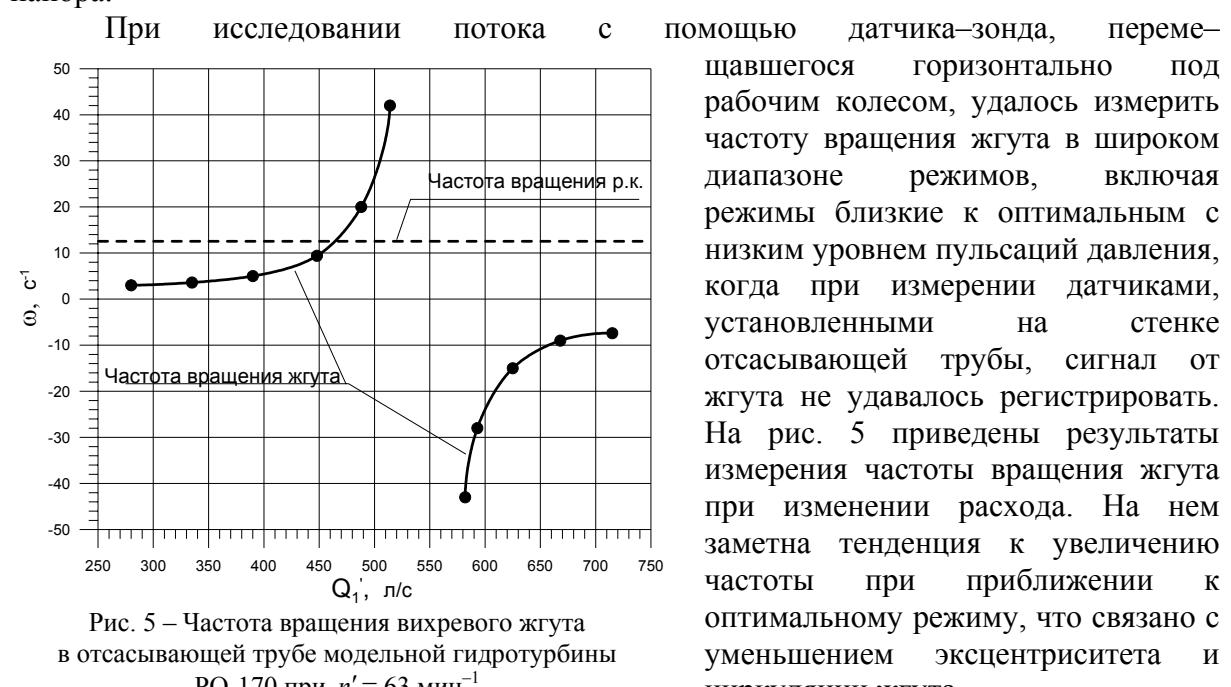
Рис. 5 – Частота вращения вихревого жгута в отсасывающей трубе модельной гидротурбины РО-170 при  $n'_1 = 63 \text{ мин}^{-1}$
