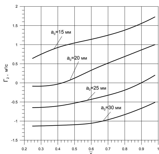
Рис. 3 – Циркуляция потока за рабочим колесом модельной гидротурбіни РО-170
