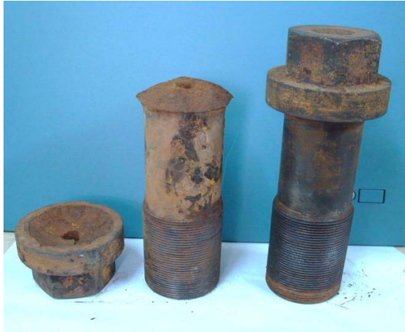
Рис. 1 – Болты крепления рабочего колеса гидротурбины (M110×4) после эксплуатации в течение 30 лет
