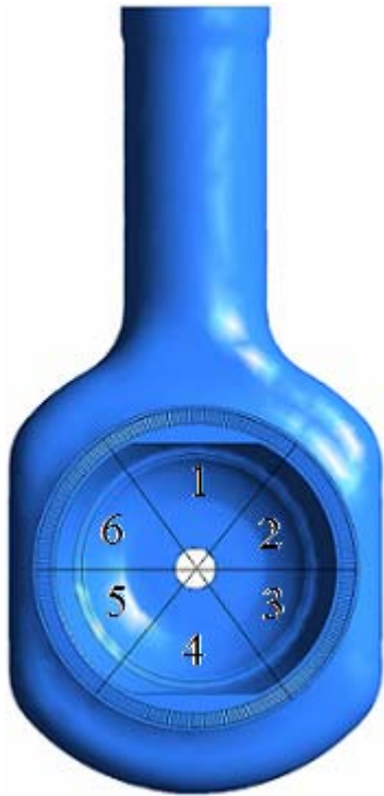
Рис. 2 – Камера сита и входной патрубков
