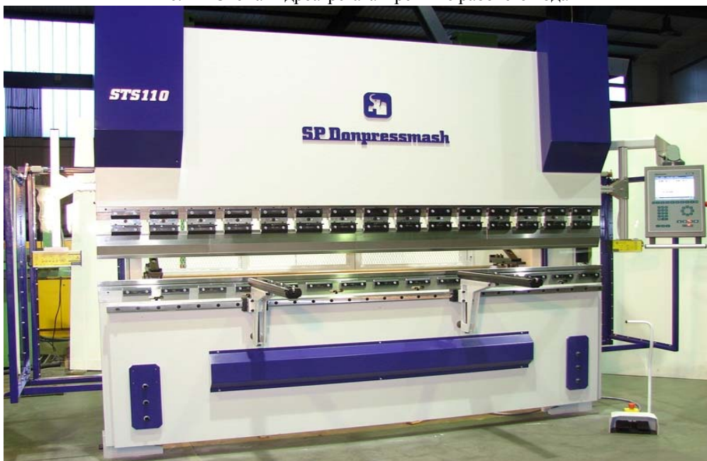
Рис. 5 – Общий вид листогибочного пресса SP Donpressmash (Россия–Германия)
