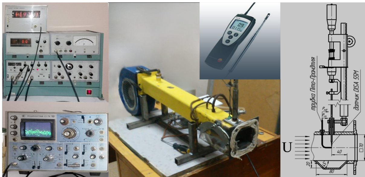
Рис. 2 – Аеродинамічний стенд з вимірювальною апаратурою
