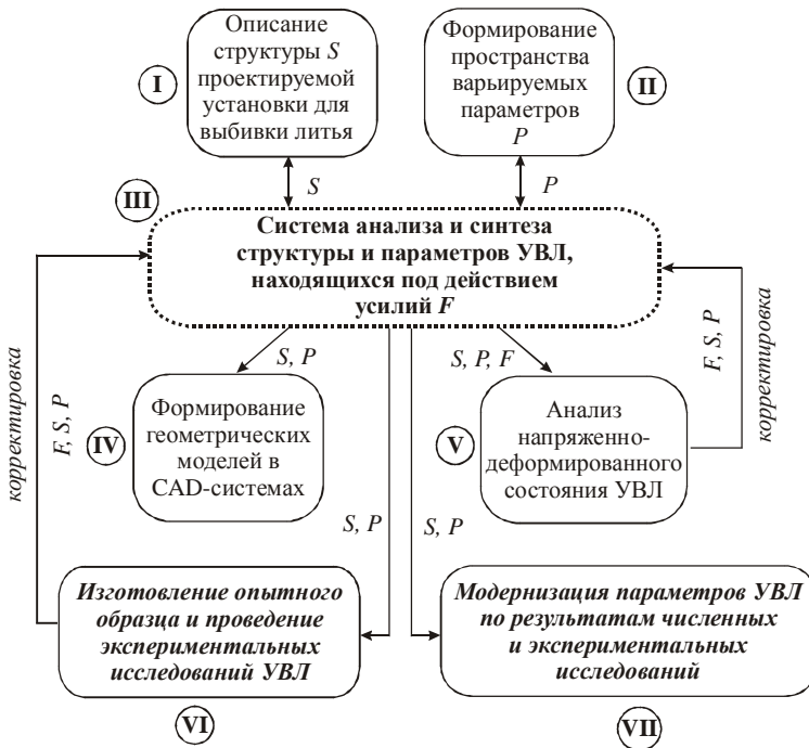
Рис. 1. Структурная схема для организации процесса исследований установки для выбивки литья
