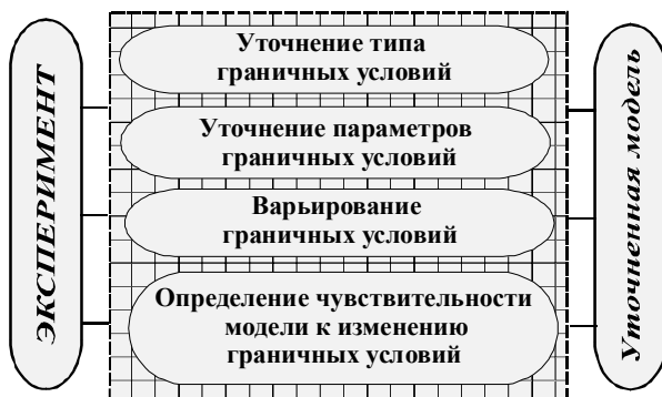
Рис. 23. Схема экспериментального уточнения граничных условий
