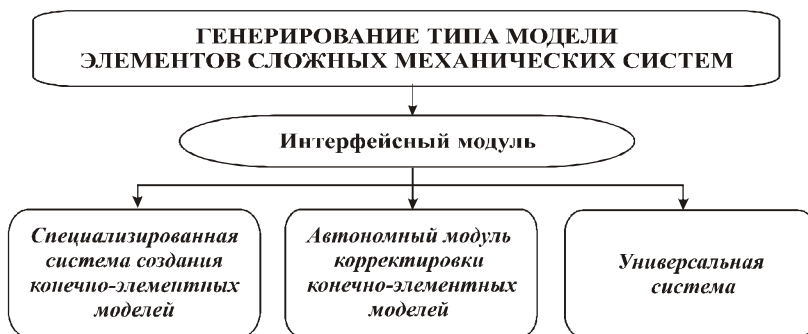
Рис. 1. Специализированная интегрированная система автоматизированного анализа и синтеза элементов сложных механических систем
