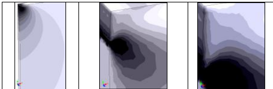
Рис. 5. Характер распределения эквивалентных (по Мизесу) напряжений в районе режущей кромки матрицы штампа высотой 30мм (область кромки выделена с разными масштабами)
