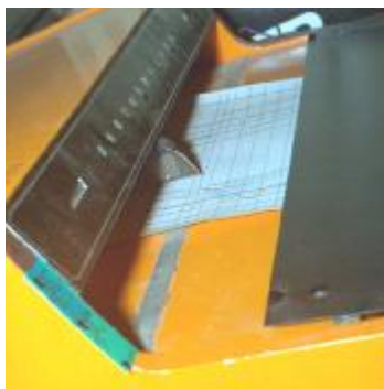
Рис.2. Вид иглы указателя устройства Ф-018 сбоку
