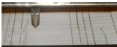
Рис.3. Вид иглы указателя при разных углах зрения оператора. Коробление фотобумаги на краях
