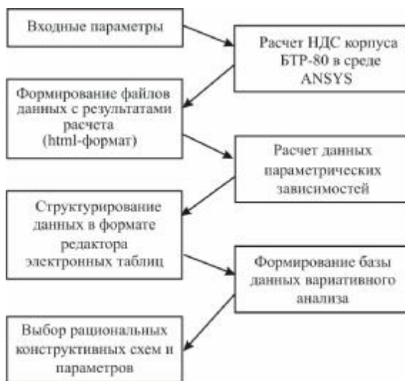
Рис. 8. Потоки данных в процессе анализа и синтеза корпусов БТР-80 при действии усилий стрельбы
