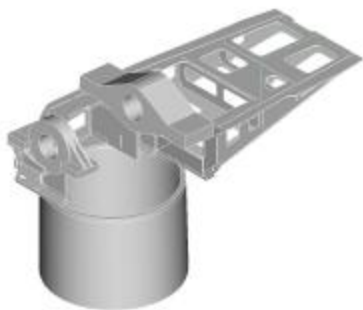
Рис. 6. Геометрическая модель рамы в сборе (половина головной части рамы условно не показана)
