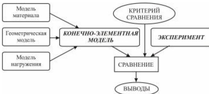
Рис. 1. Схема расчетно-экспериментальных исследований НДС конструкции
