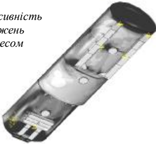
Рис. 5. Компоненти напружено-деформованого стану автоцистерни при дії ваги рідини при повороті
