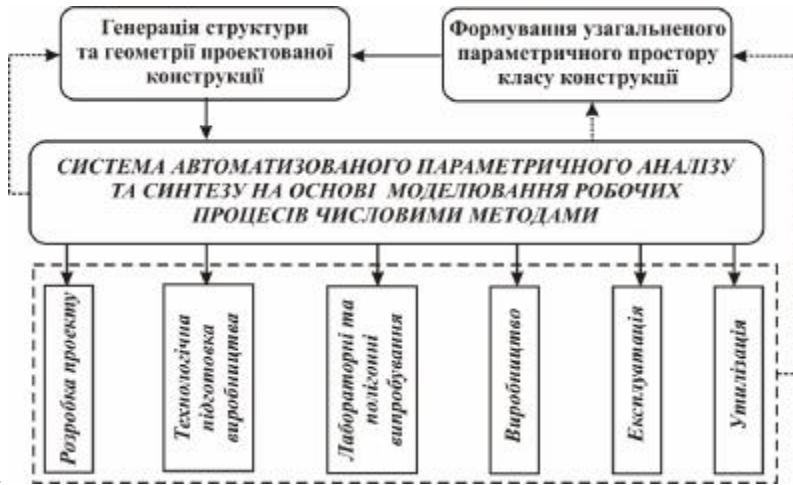
Рис. 1. Місце системи автоматизованого параметричного аналізу та синтезу машинобудівних конструкцій у загальному життєвому циклі проєктування, виробництва та експлуатації
