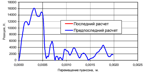
Рис. 6. Зависимость усилия штамповки от глубины внедрения пуансона
