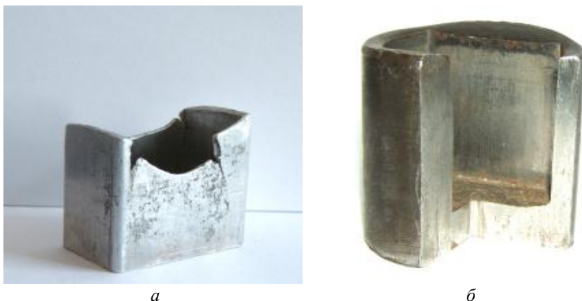
Рис.2. Возможные дефекты при выдавливании деталей сложной формы
