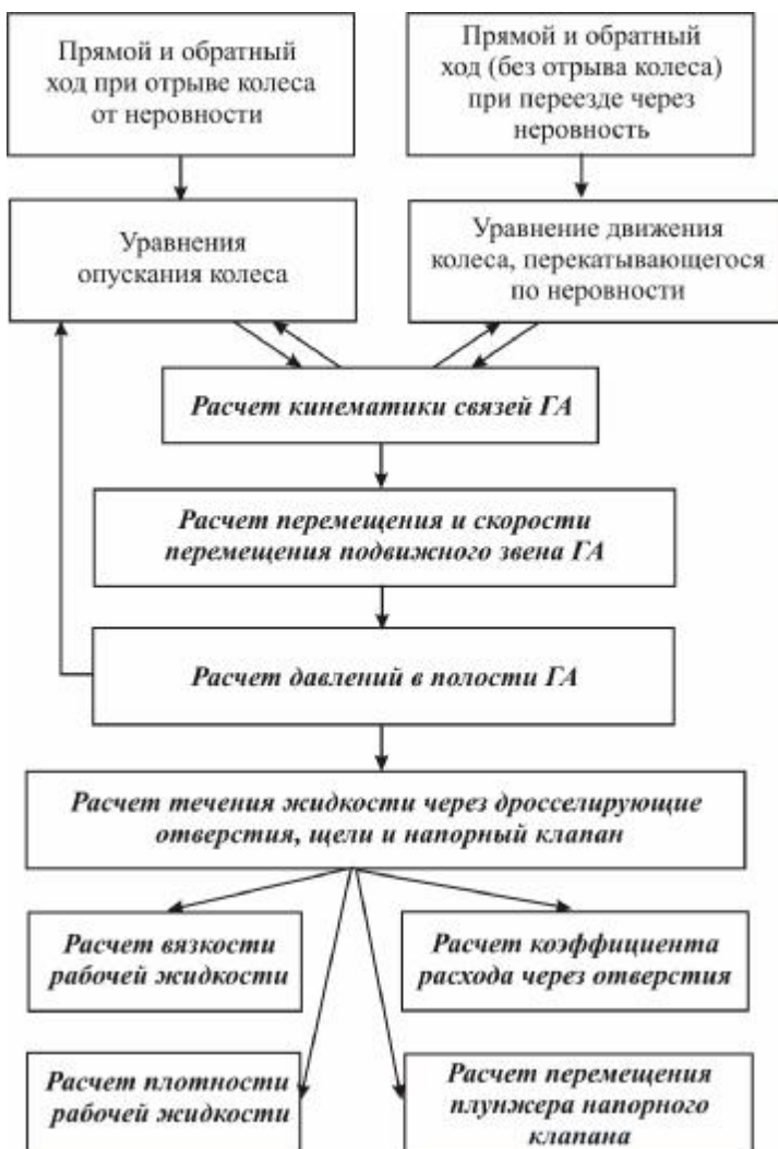
Рис.2. Структура математической модели гидравлического демпфирующего устройства (ГА – гидравлический амортизатор)
