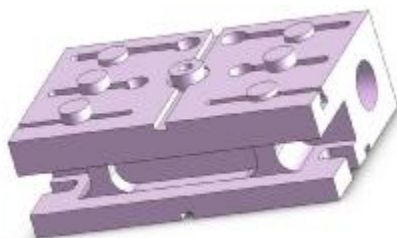
Рис. 4. Вариант конечно-элементной модели исследуемой подставки
