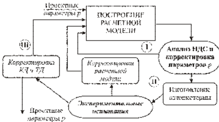
Рис.3. Процесс расчетно-экспериментального исследования напряженно-деформированного состояния автоцистерны
