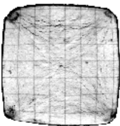
Рис. 8. Схема направления течения металла
