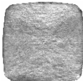
Рис. 10. Заготовка с координатной сеткой после деформации
