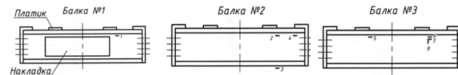
Рис. 2. Схема установки тензорезисторов на подрешетных балках
