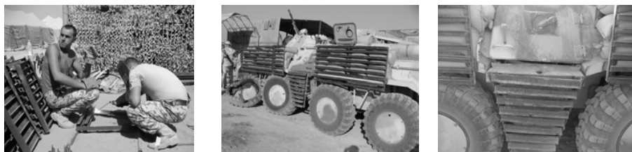
Рис. 5. Результати виготовлення гратових (гратоподібних) екранів у 62-му окремому механізованому батальйоні
