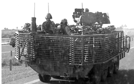
Рис. 4. Варіант підвищення захищеності, встановлений на БТТ сил коаліції (республіка Ірак)
